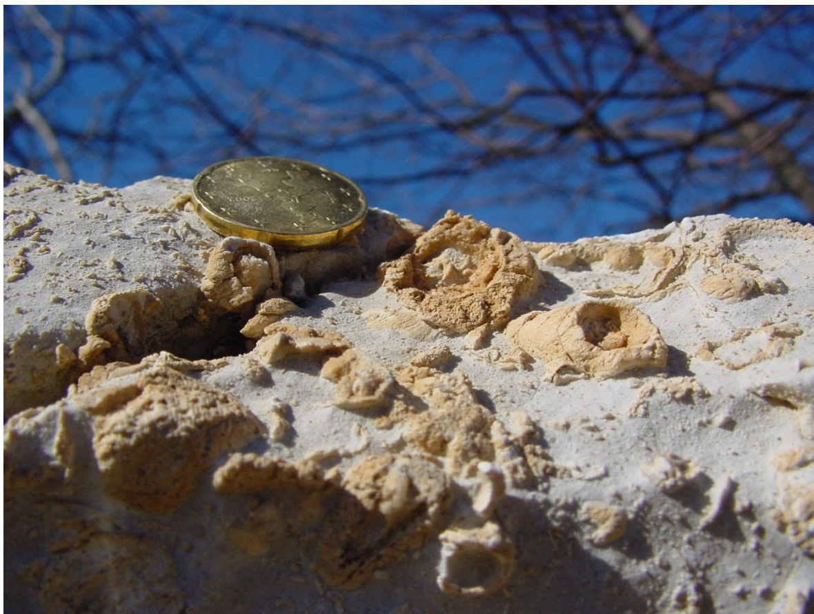
Valori medi di abbassamento annuo per corrosione di rocce carbonatiche ed esempio di corrosione differenziata (micrite / sparite)
